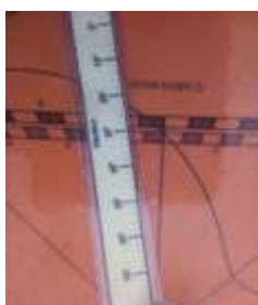
Gambar 10. Alidade Menunjukkan Nilai Umbra Versa Tinggi Kulminasi Matahari
